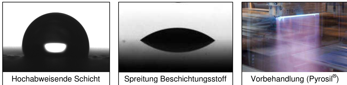
Abb. 7: Dilemma bei Trennschichten: Erzeugung einer haftesten Beschichtung, an der Nichts haftet (Vorbehandlung notwendig)
