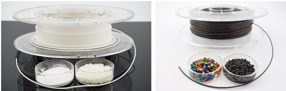
Re- und Upcycling von 3D-Druck-Abfällen – Aufbereitung mit dem Zweischnellenextruder – Weiterverarbeitung mittels Kompaktextruder zu neuwertigem Filament; links: PA12-Altpulver aus dem SLS-Prozess; rechts: PLA-Abfälle aus dem FDM-Druck
