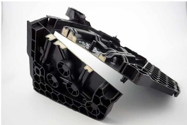
Optimiertes Funktionsträgerbauteil mit geschäumter Kernschicht
