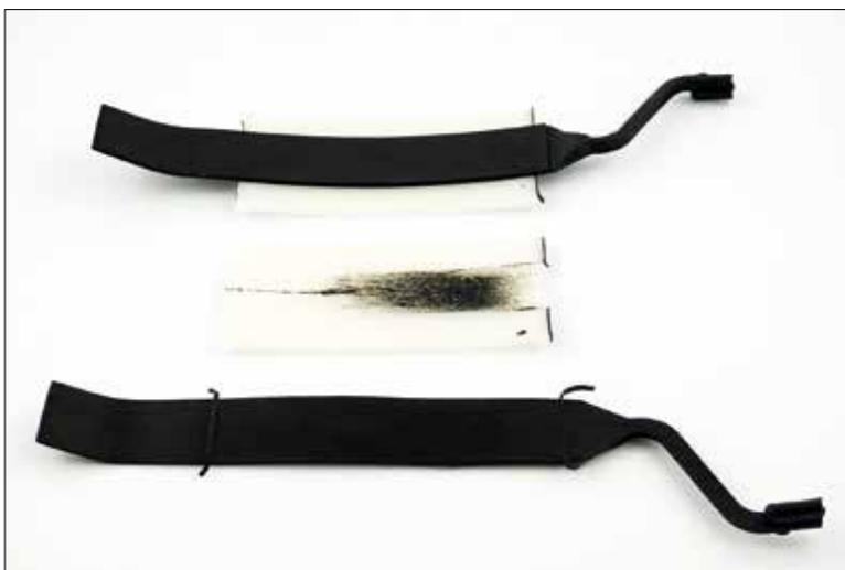
Bild 5: Abrissverhalten der angespritzten Rußcompounds von PP (oben) und PA6 (unten) im Rollenschälversuch.
