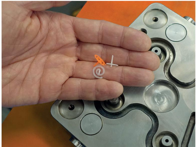
Vorteil auch einen raschen Farbwechsel. Im Versuch mit dem Formteil „Klemme“ hat sich gezeigt, dass ein Formmasse- oder Farbwechsel mit 2-maligem Durchspülen des Schmelzeverteilers mittels Durchspritzen mit dem Spritzaggregat realisierbar ist.
