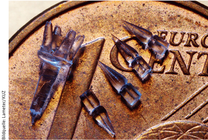
▲ Biochips mit Mikrofluidikstrukturen für PCR-Erkennung
