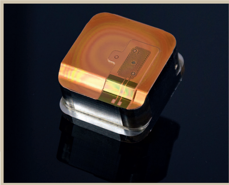
Bild 2. Werkzeugeinsatz mit Heizstruktur aus Kupfer
