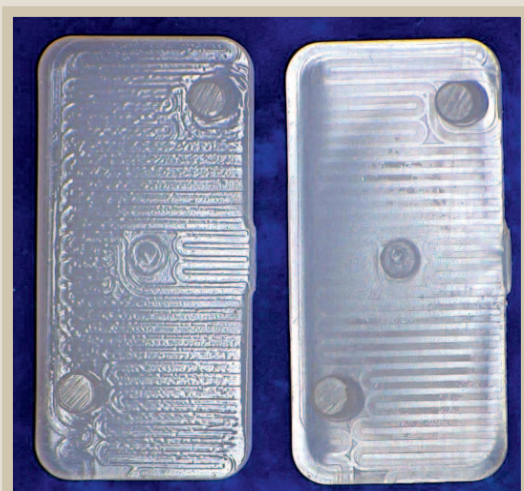
Bild 5. Vergleich der Abformung des Demonstrationsformteils flächig im Mikrospritzguss aus POM (Ansicht der auswerferseitigen Kontur).
